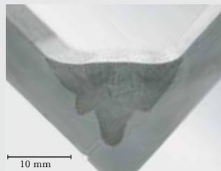
/ Aus der Drahtvorschubgeschwindigkeit von 25 m/min resultiert eine Abschmelzleistung von 13,5 kg/h.
