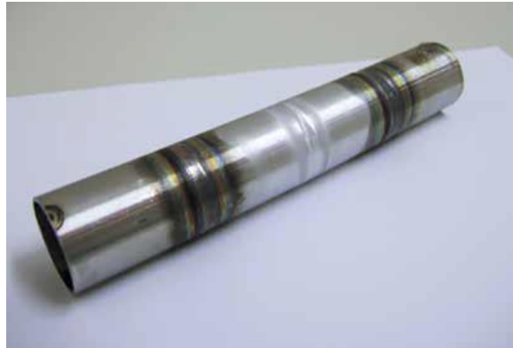
Mitte: Mit Antox® behandelte Schweissnaht Rechts und links: Unbehandelte Schweissnaht mit
