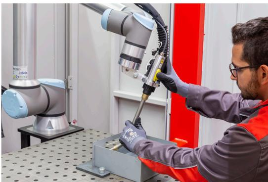
/ Einfache Programmierung durch direktes Führen des Brenners
